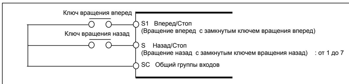
**• Работа по 3-проводной схеме (п052 = 0)**
