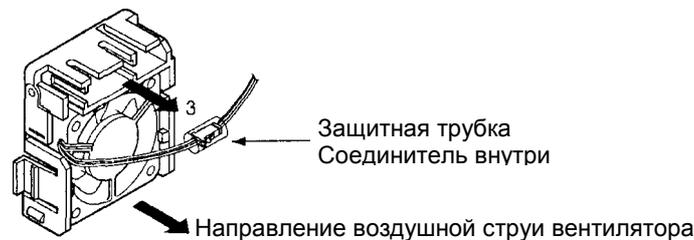
3. Сдвиньте защитную трубку и вытащите внутренний разъем.
