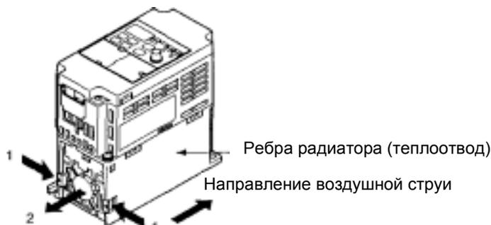
2. Придерживая провод вентилятора, потяните защитную трубку в направлении стрелки 3.
